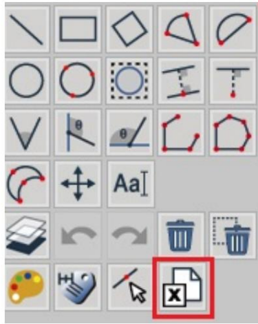
Fig. 1-11 Icono de exportación de datos que se muestra en las herramientas de medición.
